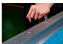
Направляющие с покрытием Turcite-B
